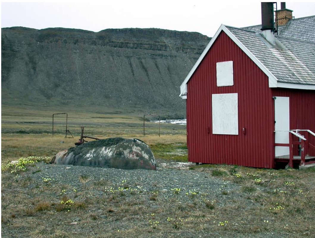
Et fremmedlegeme som denne nedgravede olietank ved et forladt bygning i Dundas har permafrosten presset op til overfladen. Bygningen var frem til 1954 sygehus. Juli 2002.
